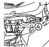
5. 手順4のケーブルの反対側④を自車の車体（2の手順で接続した⊕端子から離れたステーなど）に接続します。
