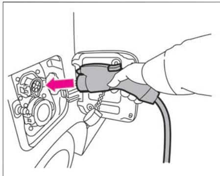
6. 充電コネクタを“カチッ”と音がするまで差し込みます。正常に接続されると、ブザーが1回鳴ります。また、充電ポートの照明が自動的に消灯します。
