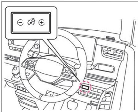
パワースイッチがONのとき、メーター照明の明るさを調節できます。
