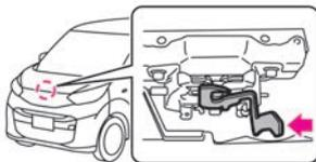
2. ボンネット先端のすき間に手を入れ、レバーを横に押しながらボンネットを持ち上げます。
