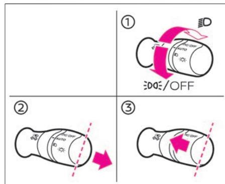
次のいずれかの操作をすると、アダプティブLEDヘッドライトシステムがOFFになります。
