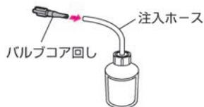
7. 注入が終わった空ボトルから修理剤が漏れるのを防ぐため、注入ホースの先端にバルブコア回しを差し込んで栓をします。
