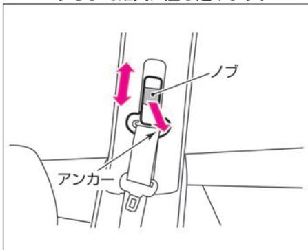
3. アンカー位置の高さを調節します。
