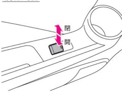
運転席のスイッチで、各席の窓ガラスの開閉ができます。助手席のスイッチおよび後席のスイッチでは自席の窓ガラスの開閉ができます。
