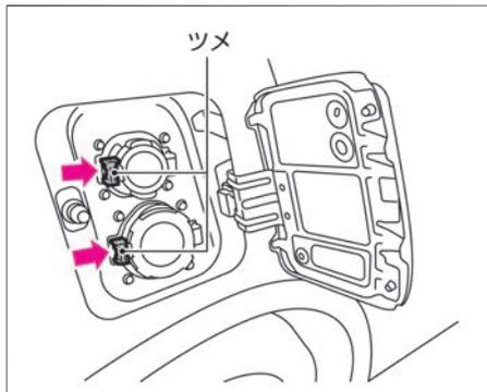
2. 使用する充電ポートキャップに付いているツメを押して、充電ポートキャップを開きます。（急速充電ポート：下側、普通充電ポート：上側）
