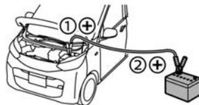
3. 手順2のケーブルの反対側②を救援車の12Vバッテリーの⊕端子に接続します。
