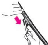
3. ワイパーブレードを矢印の方向に動かして取り外します。
