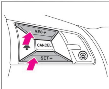
設定車速が5km/hきざみで変更できます。
