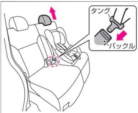
1. ヘッドレストを外し（ヘッドレストとチャイルドシートが干渉してチャイルドシートを正しく取り付けられない場合）、チャイルドシートを座席に置きます。
