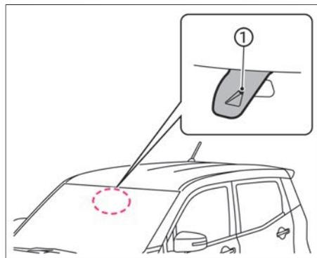
フロントガラス上部に周囲の状況を検知するためのカメラ①があります。アダプティブLEDヘッドライトシステムを正しく作動させるため、次のことをお守りください。
