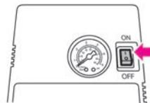
5. エアコンプレッサーのスイッチをONにし、タイヤを指定空気圧まで昇圧させます。
