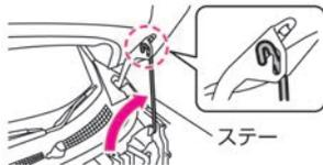
3. ステーをフックから外し、ボンネット裏側の穴（ステー差し込み位置）に確実に差し込みます。
