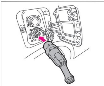
4. 充電器本体の手順に従い、急速充電コネクタを充電ポートの溝に合わせて根元まで確実に差し込み固定します。
