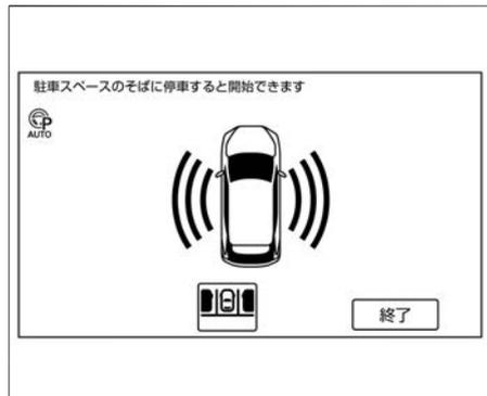
駐車位置検出中に車速が約10km/h以上になると、上の画面へ切り替わります。車速が約10km/h以下になると、通常のプロパイロットパーキング画面に戻ります。
