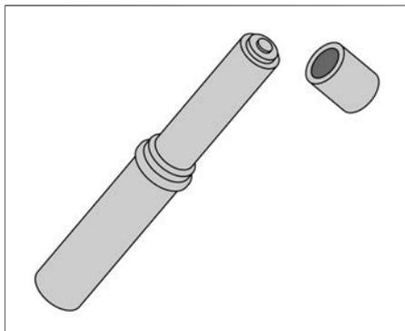
3. 先端のふたを取り、ケースのすり薬で発炎筒の先端をこすって着火します。
