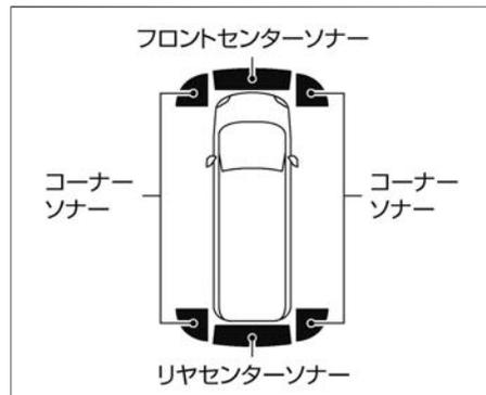
● インテリジェント アラウンドビューモニター (移動物 検知機能付) を表示させて、走行中にソナーが静止した障害物を検知した場合は、ソナー表示とブザーでお知らせします。
