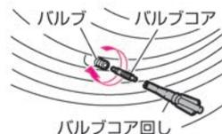
6. 注入し終わったら、注入ホースをバルブから引き抜き、バルブコア回しを使ってバルブコアをバルブにしっかりとねじ込みます。
