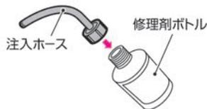
2. 修理剤ボトルの内ぶたを付けたまま注入ホースをねじ込みます。(注入ホースをねじ込むと内ぶたが破れます。)
