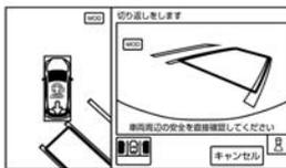
7. 切り返し目安枠（緑色）に到達するとシフトポジションが自動で切り替わり、車両が後退します。障害物などがあり切り返し目安枠に到達できない場合は、ブレーキペダルを踏んで障害物の手前で車両を停止させ、セレクトレバーで進行方向を切り替えてください。
