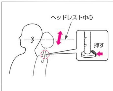
ヘッドレストの中心が、耳の高さになる位置に調節します。
