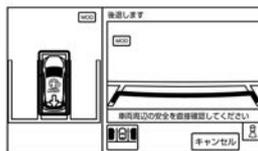
8. 駐車目安枠（赤色）に到達すると車両が停止し、駐車制御が終了します。駐車制御が終了すると、音と表示でお知らせします。そのとき、シフトポジションが **R** に切り替わり、電動パーキングブレーキが作動します。駐車目安枠（水色）に到達する前に駐車制御が自動で終了することがあります。
