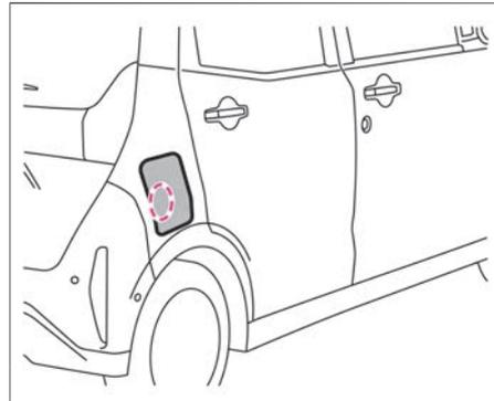
1. リッドを開けます。リッドの車両後方側中央部あたり(イラストの点線部分)を押すとリッドが少し開きます。開いたすき間に手を入れて全開します。
