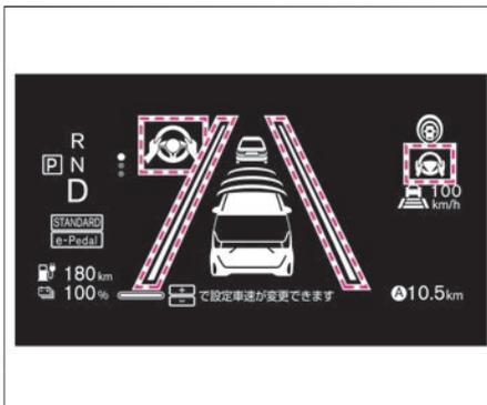
車線中央付近を走行するようにステアリングを制御し、運転者のハンドル操作を支援します。
