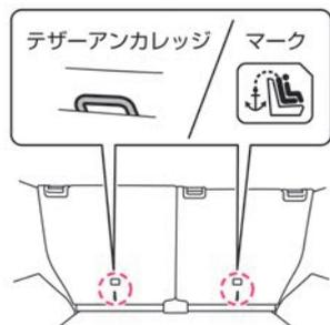
2. テザーアンカレッジは、後席シート背もたれ裏側にあります。テザーアンカレッジにフックを固定し、テザーベルトを締めます。チャイルドシートを前後左右にゆすり、しっかり固定されていることを確認します。
