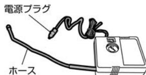
1. エアコンプレッサーに格納されているホースと電源プラグを取り出します。
