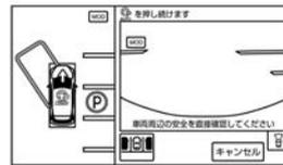
6. **プロパイロットパーキングスイッチ**を押したままでブレーキペダルを徐々にゆるめて車両をゆっくりと前進させます。繰り返し目安枠の方向（矢印の向き）に車両が移動します。周辺状況に応じてブレーキペダルを踏んで車速を調整してください。
