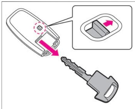
1. キー裏側のロックを外しながら、内蔵キー（メカニカルキー）を引き抜きます。
