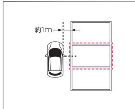
ゆっくりと前進し、駐車位置に垂直になるようにブレーキペダルを踏んで車両を停止させてください。自車の運転席ドア付近が駐車したい場所の中央付近になるように車両を停止させてください。
