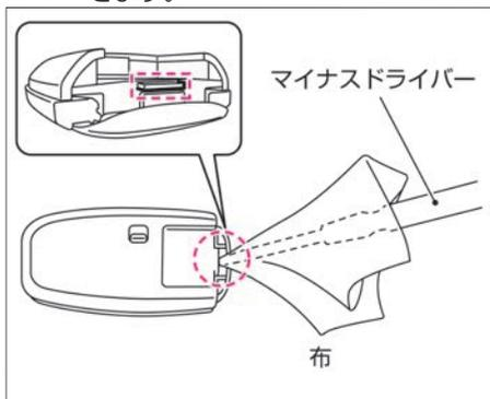
2. すき間にマイナスドライバーを差し込み、ひねってカバーを取り外します。（カバーが傷つかないように、マイナスドライバーに布を巻いてく
