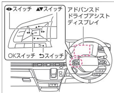
1. ステアリングスイッチの スイッチを数回押し、アドバンスドドライバアシストディスプレイに **設定** 画面を表示します。
