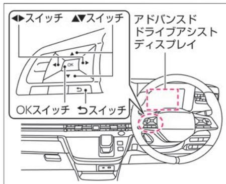
1. ステアリングスイッチの◀▶スイッチを数回押し、アドバンスドドライバアシストディスプレイに**設定**画面を表示し**OK**スイッチを押します。
