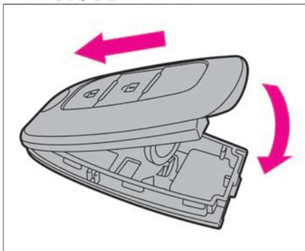
4. カバーの先端を合わせて上下のカバーを組み付けます。確実に取り付けられたことを確認してください。
