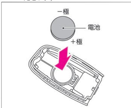
3. 消耗した電池を取り外し、新しい電池をはめ込みます。（新しい電池は、+ 極を下にして取り付けてください。）
