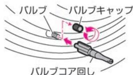
3. パンクしたタイヤのバルブからバルブキャップを外し、ビニール袋に入っているバルブコア回しの後ろでバルブ内のバルブコアを押し、タイヤの空気を完全に抜きます。
