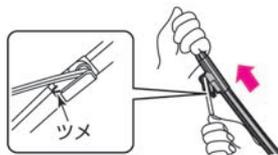
4. 新しいワイパーブレードを取り付けます。取り付けは取り外したときと逆の手順で行い、ワイパーブレードが確実に固定されていることを確認します。
