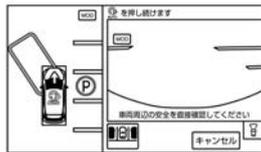
5. ブレーキペダルを踏んだまま画面上の**駐車開始**をタッチします。駐車制御を開始します。制御を開始するとプロパイロットパーキング制御アイコン (◎) が表示され、自動でブレーキをかけて停車状態を保持します。ソナー、カメラで検出した障害物により駐車位置まで移動できないと判断した場合は、駐車制御が開始されません。その場合は通常走行で駐車を行ってください。
