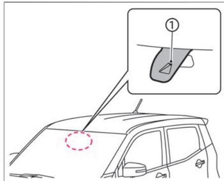
フロントガラス上部に周囲の状況を検知するためのカメラ①があります。ハイビームアシストを正しく作動させるため、次のことをお守りください。
