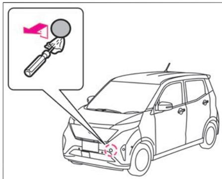
1. 先の細いお手持ちの工具を布などで覆い、フロントバンパーのカバーの溝に差し込んでカバーを外します。
