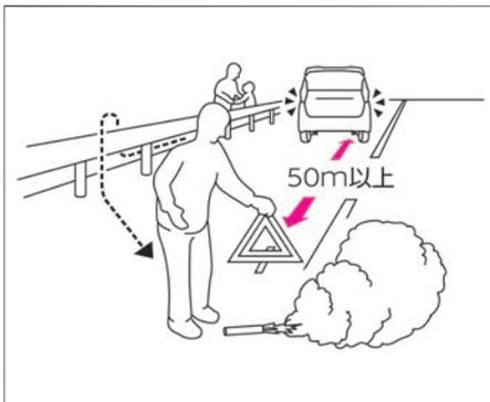
2. 同乗者をガードレールの外側などに避難させ、車両の50m以上後方に発炎筒と停止表示板（停止表示灯）を置きます。
