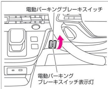
2. **電動パーキングブレーキスイッチ** を引きません。スイッチを引くと、**電動パーキングブレーキスイッチ** の表示灯が点灯し、メーター内の電動パーキングブレーキ警告灯 **Ⓟ** が、約2秒後に点灯します。
