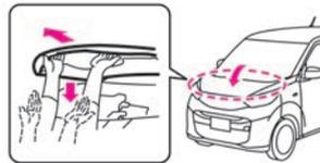
4. 閉めるときはステーをフックに戻し、ボンネットを20cm～30cmの高さまでゆっくり降ろしてから、手を離して落としてロックします。ロックできなかったときは、レバーを操作してボンネットをもう一度持ち上げてから再度落としてください。ボンネットを上から押して閉めようとししないでください。
