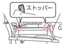
2. グローブボックスを開け、左右のストッパーを外します。
