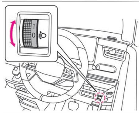
ヘッドランプが下向きするとき、ダイヤルを回して調節します。
