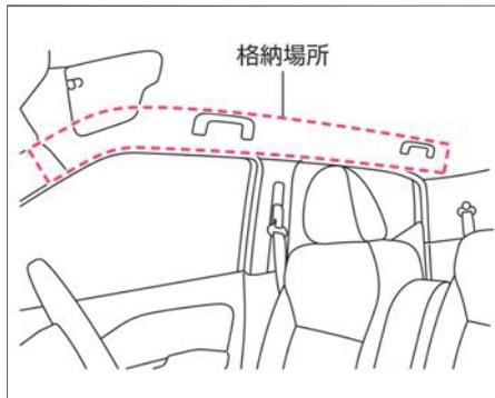
SRSカーテンエアバッグは、運転席側、助手席側ともに窓側の天井部に格納されています。
