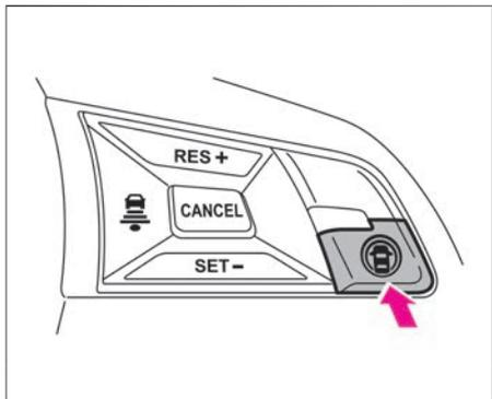
1. ハンドルにある **プロパイロットスイッチ** を1.5秒以上押して定速制御機能をON（待機状態）にします。アドバンスドドライブアシストディスプレイに定速制御機能表示が点灯します。
