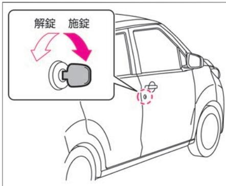
運転席ドアにある鍵穴に内蔵キーを差し込んで車両後方に内蔵キーを回すと解錠します。施錠するときは、車両前方に内蔵キーを回します。
