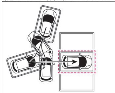
図のような経路で駐車制御を行います。駐車経路、切り返し回数は駐車位置、周辺の障害物の位置により異なります。
