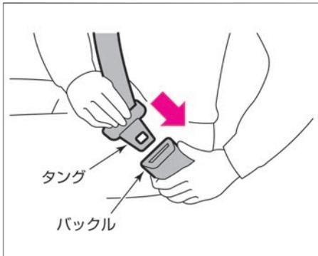
2. ベルトがねじれないようにして、タングをバックルに“カチッ”と音がするまで確実に差し込みます。
