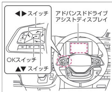
1. ステアリングスイッチの◀▶スイッチを数回押し、設定画面を表示してOKスイッチを押します。
