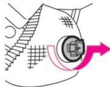
7 古い電球を引き抜き、新しい電球をソケットに取り付けます。
