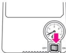
6 指定空気圧まで昇圧できたら、エアコンプレッサーのスイッチをOFFにし、電源プラグを電源ソケットから抜きます。
