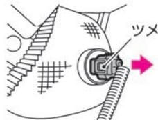
6 ソケットを矢印の方向に回して引き抜きます。
