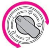
2 内外気切り替えレバーで、内気循環・外気導入を切り替えます。
