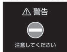
進入禁止標識検知表示
