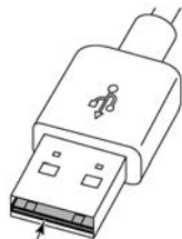
リバーシブルタイプUSBコネクタ (接点基板が中央にある)
