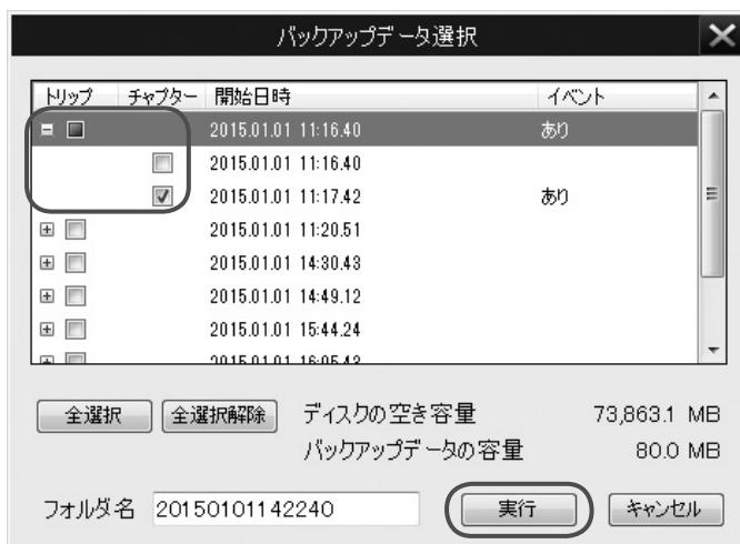
選択した記録データが、指定した保存先にバックアップ(保存)されます。フォルダーネームはバックアップ実行日時が初期表示されます。
