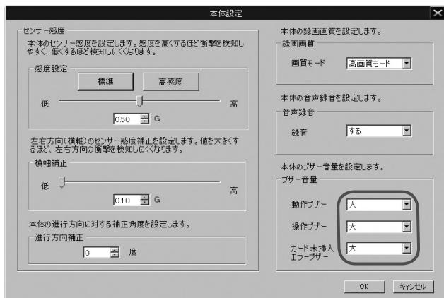
映像を記録する時などに鳴る動作ブザー、またはイベント（操作）ブザー、カード未挿入時のエラーブザーの音量を指定します。
