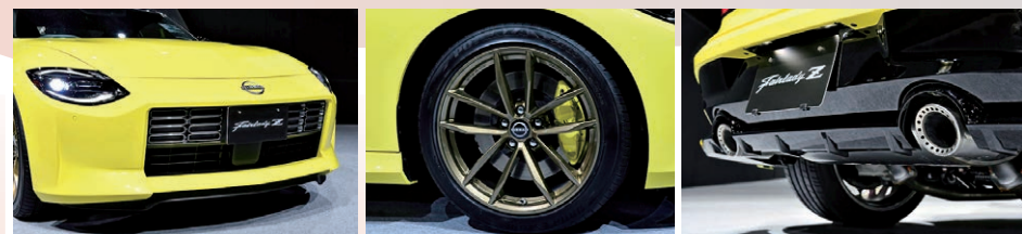
(1) 歴代Zの伝統と405PSを發揮するエンジンの冷却を両立させたグリル (2) 専用カラーのレイズ製19インチアルミ鍛造ホイールとイエローのブレーキキャリパー (3) 大径マフラーとリヤにはディフューザー
