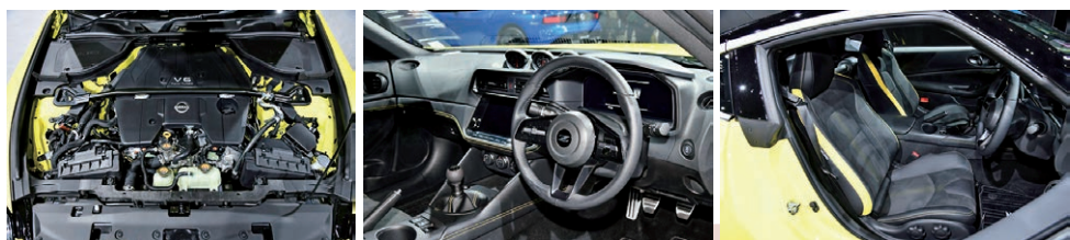
(1) VR30DDTT型エンジンは最高出力298kW (405PS)、最大トルク475N・m (48.4kgf・m) を発生 (2) 松田次生選手と共同開発したメーターを設えるインパネ (3) ボディカラー同様イエローが光るインテリア
