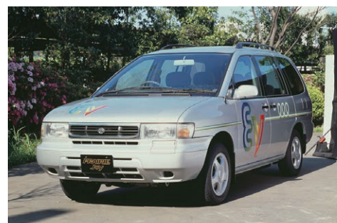
リチウムイオンバッテリー（円筒型）を搭載した世界初の電気自動車として発売されたプレリージョイEV
