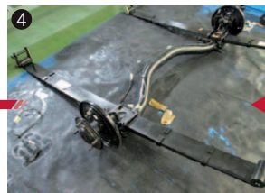
④ リーフスプリングを使ったド・ディオ・アクスルのリヤサスペンション
