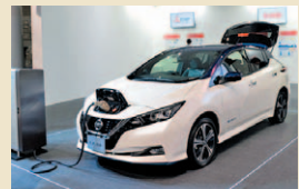
家とクルマで電力を相互供給できる「Vehicle-to-Home (V2H) システム」で未来の家を提案。太陽光発電した電気を日産リーフに貯めることで、電化製品への電力供給を可能に
