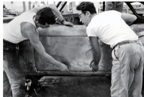
カロッツェリアの板金職人と共にアッセンブリー。加工の仕上がりをチェックするため毎日ボディを撫でて、当時は指の皮がなくなっていたとか
